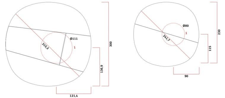
**2** Scatole predisposte per l'elettrificazione - Electrical outlet hinged - Boîtes prédisposées pour l'électrification
