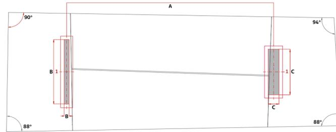
**A** Interasse filo basi / Wheelbase / Entraxe sur l'axe des bases / Distancia linea bases / Abstand zwischen Untergestellen
